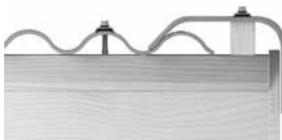
rys.40. Montaż wiatrownicy o zagiętym ramieniu.
