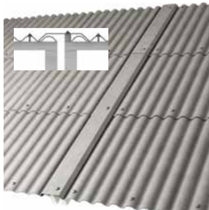
rys.42. Sposób montażu gąsiorów dylatacyjnych.
