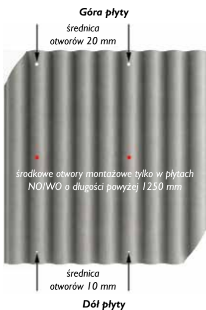
rys.22. Płyta EuroFala B59 NO/WO - rozmieszczenie obciętych narożników i otworów montażowych. Płyty EuroFala B65 NO/WO mają otwory montażowe na szczytach 2 i 5 fali.
