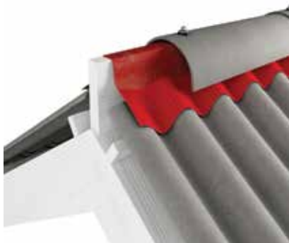
rys.7. Gąsior konikalny / stożkowy z taśmą kalenicową - powierzchnia wentylacji na 1 mb kalenicy: płyta B59 - 150 cm 2 ; płyta B65 - 255 cm 2 na każdą połac.
