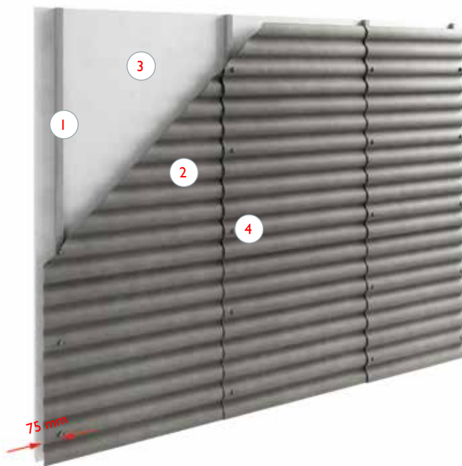
rys.52. Montaż płyt na elewacji/ścianie poziomo z zakładem podłużnym (na jedną falę) i z zakładem poprzecznym (150 mm). 1 - łąty prostopadłe do poziomemu gruntu 2 - płyta EuroFala mocowana z zakładem podłużnym (na jedną falę) i z zakładem poprzecznym (150 mm) 3 - istniejąca wcześniej elewacja/ściana budynku 4 - punkty mocowania płyt - dla płyt B59 na szczytach 2 i 6 fali, dla płyt B65 na szczytach 2 i 5 fali
