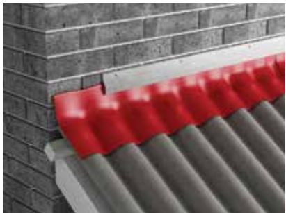
rys.44. Wykończenie styku połączenia dachowego ze ścianą.
