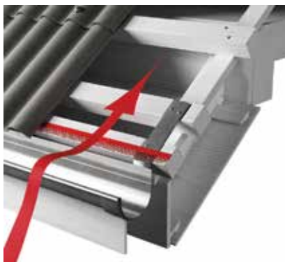
rys.5. Grzebień okapowy - powierzchnia wentylacji na 1 mb okapu: płyta B59 - 120 cm 2 ; płyta B65 - 200 cm 2 .
