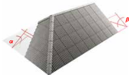
rys. 37. Nachylenie połaci dachowych przecinających się w narożu.
